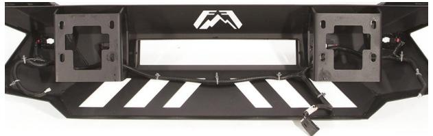
Figure 9a (OVERALL SENSOR HARNESS ROUTING)
