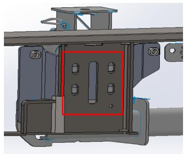
Figure 7b (stud plate loc.)
